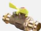
Profifress G-plynový kulový kohout s SC-Contur - lisovací přípoje - lze uzavřít Vybavení kryt z červeného bronzu, ovládací rukojeť z ocelového plechu je ošetřena žlutou práškovou barvou, zkušební otvor, těsnění HNBR Technická data VTZ (vyšší teplotní zátěž) 650 °C / 30 min GT1 provozní tlak max. 0,5 MPa (MOP 5) se zkušební značkou DIN-DVGW-G model 2671
